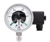
Тип ТМ (ТВ, ТМВ), серия 21. Промышленный манометр, устойчивый к воздействию агрессивных измеряемых сред, с возможностью гидрозаполнения (виброустойчивый). Оснащен электроконтактной приставкой для управления внешними электрическими цепями. Электрическая схема: двухконтактная Исп. III (ЛРПР)\*, Исп. IV (ЛЗПЗ)\*, Исп. V (ЛРПЗ) или Исп. VI (ЛЗПР).
